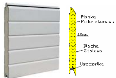
Rys. 3. Poszycie bramy – przekrój pionowy
